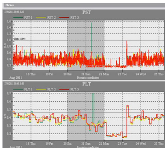
Reporte gráfico de Flicker obtenido con un registrador modelo PQ500 y software Sistema Ecamec 2.0
